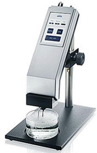
Отобрав из ванны пробу с неизвестной концентрацией и измерив динамическое поверхностное натяжение, из калибровочной кривой можно определить концентрацию поверхностно-активного вещества в ванне в любой момент времени.
