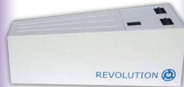
Реометр порошков Revolution оценивает склонность порошков к течению, консолидации, грануляции, трамбованию и упаковке. В консолидированном состоянии порошок более похож на твёрдое вещество и может даже становится твёрдым при больших нагрузках. При движении или вибрации порошок становится похож на жидкость – так называемое оживленное (псевдооживленное) состояние.
