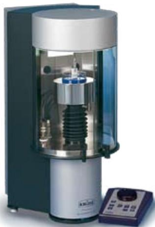
Процессорный тензиометр K100 может определять смачиваемость порошков по методу Вашбурна. Данный метод применим только к материалам, которые смачиваются (краевой угол <math><90^\circ</math>) жидкостями.
