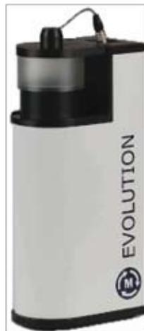
Реометр порошков Evolution позволяет определить неограниченную силу сдвига (критическую точку течения) порошков и гранул, т.е. силу, необходимую для разрушения/деформации свободно лежащего материала. Эта сила может измеряться как при одном значении давления, так и при нескольких, что позволяет построить функцию течения.
