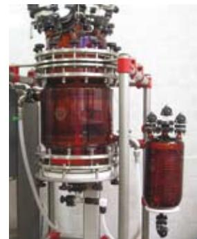
В нутч-фильтре с рубашкой можно проводить синтезы, в ходе которых выпадает осадок. После стадии реакции осадок легко отделить от жидкости (отфильтровать) и снять с фильтра.
