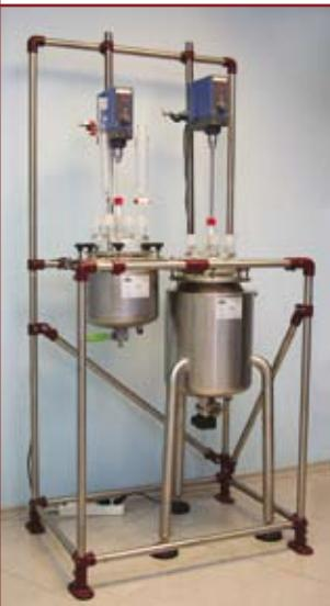
Реакторы могут располагаться на трёх опорах или на опорном стендце. Исполнение зависит от комплектации системы, а также от пожеланий пользователя.
