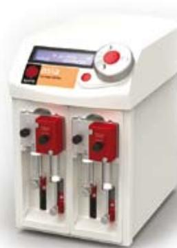
К насосу можно подключить датчик температуры и датчик pH. Если по одному каналу насоса подавать кислоту, а по другому – щёлочь, то насос сможет автоматически поддерживать заданный уровень pH.
