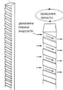
В центре корпуса вращаются лопасти с косыми зубцами. Такая форма позволяет размазать стекающую жидкость по тонкий слой.
