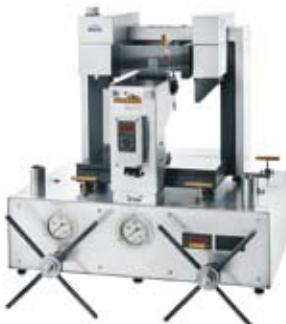
Приборы DSA 100 могут работать с камерами высокого давления для изучения пластовых процессов.
