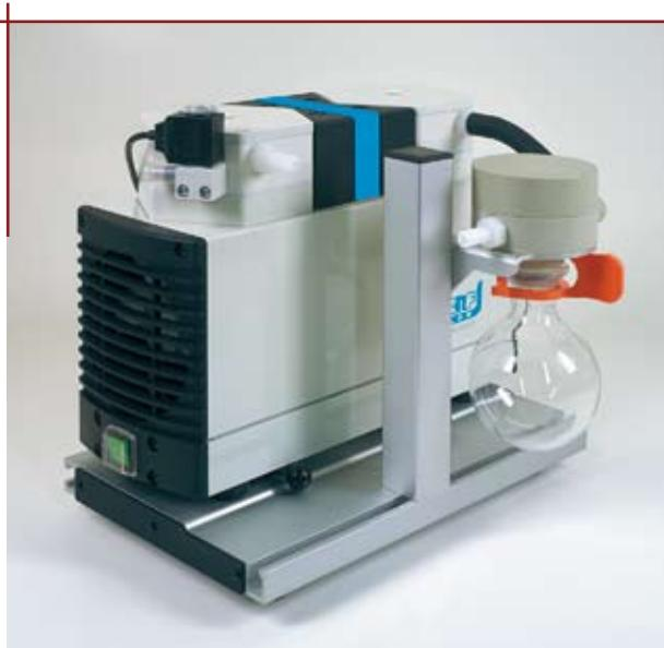
Вакуумные системы для влажных газов оборудованы фильтром и приёмной сферической колбой. Колба имеет стандартный сферический шлиф и крепится с помощью клипсы.
