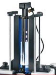
Модуль электропроводности применяется для определения воды в пене. Для этого в пену опускают держатель с 7-ю парами электродов. Пена не проводит ток, а вода проводит.
