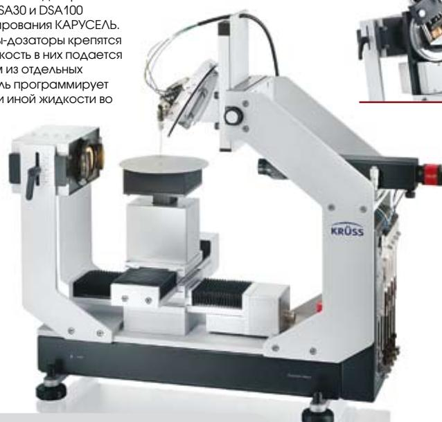
Наличие автоматической системы дозирования и хотя бы одной автоматической оси позволяет построить энергетическую карту поверхности. Краевые углы на разных жидкостях измеряются по всей поверхности по заданной траектории.
