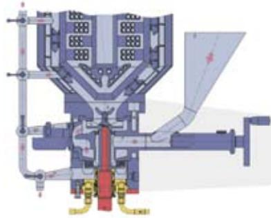
Сухие и жидкие компоненты подаются сразу в камеру диспергирования (2-я стадия), что позволяет избежать образования комков при контакте жидкости с сухой фазой.
