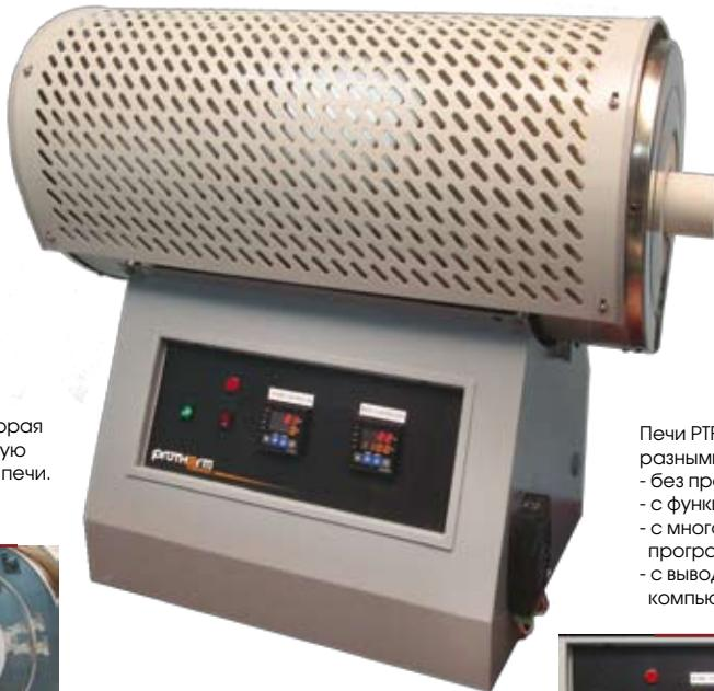
Продукт загружается во внутреннюю кварцевую трубу, которая вставляется в наружную керамическую трубу печи. Во внутреннюю трубу можно подавать газ.
