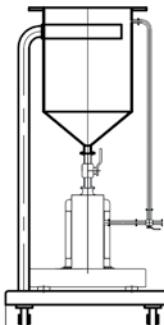
Металлические реакторы Conny спроектированы для работы с диспергаторами, в том числе с проточными гомогенизаторами. Благодаря коническому дну, можно работать с небольшим объёмом продукта.
