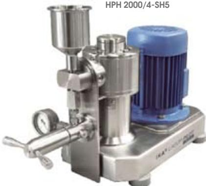
Возможна поставка гомогенизаторов двух типоразмеров с одним или двумя поршнями различных диаметров. Максимально возможное давление гомогенизации составляет 800 или 2 000 бар. Минимальный объём обрабатываемого продукта – 10 мл.
