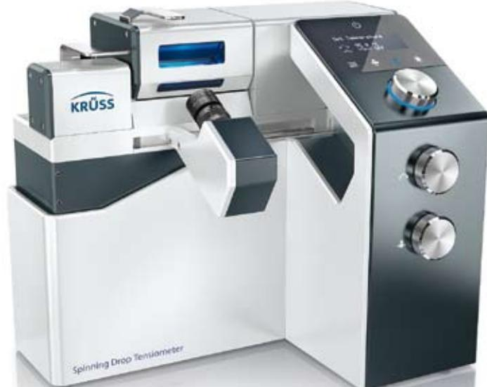
Тензиометр SDT управляется с передней панели и с компьютера. Анализ видеоизображения капли производится программным обеспечением ADVANCE.
