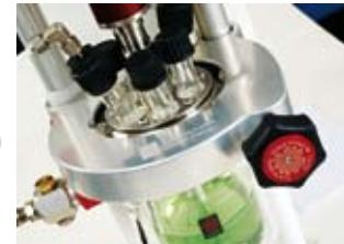
Модификация Globe HP оснащена стеклянной толстостенной ёмкостью, усиленным крепёжным кольцом и крышкой с резьбой GL.
