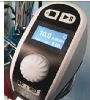
На панели управления отображается скорость дозирования, объём поданного реагента, время дозирования.
