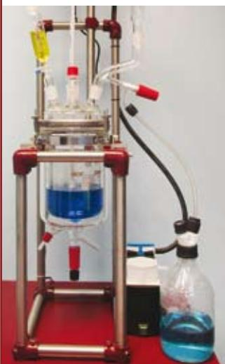
Для отгонки растворителя во время синтеза реактор Unic может быть оснащён S-адаптером с вертикальным конденсатором. Эта схема позволяет как возвращать конденсат в реактор, так и отводить его в ёмкость.
