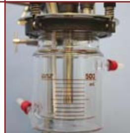
Для получения эмульсий и супензий вместо мешалки может быть закреплён погружной диспергатор.
