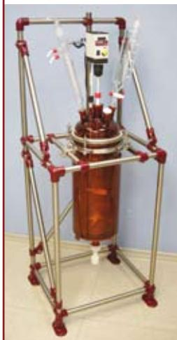
Для отгонки растворителя во время синтеза реактор Steddy может быть оснащён S-адаптером с вертикальным конденсатором. Эта схема позволяет как возвращать конденсат в реактор, так и отводить его в ёмкость.
