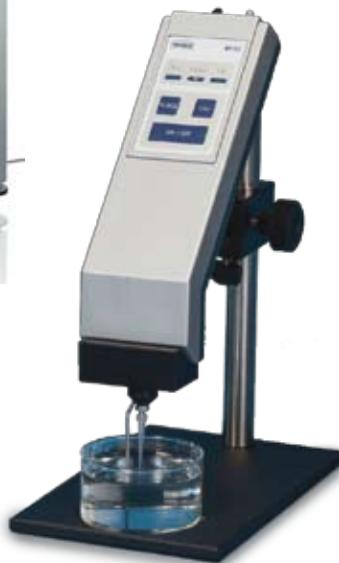
Тензиометры ВР незаменимы для контроля качества растворов в быстропротекающих процессах, таких, как печать, распыление или нанесение покрытий. В таких процессах ПАВ должны за минимальное время дойти из объема до поверхности жидкости и снизить ее поверхностное натяжение. Чем ниже поверхностное натяжение, тем проще жидкость "цепляется" за поверхность (бумагу, лист растения, слизистую и т.п.).
