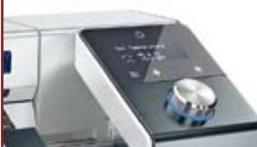
Тензиометр по методу вращающейся капли позволяет определить очень малое межфазное натяжение, которое характерно для органических растворов, к примеру, нефтепродуктов. В частности, данный тензиометр широко применяется для оптимизации свойств буровых растворов и жидкостей заводнения для ГРП. Поэтому данный тензиометр еще называют «пластовый тензиометр».
