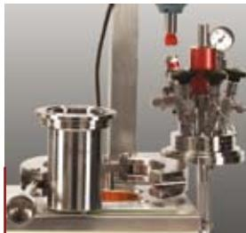
На крышке реакторов Premex размещены: мешалка, клапан подачи газа, клапан сброса давления, предохранительный клапан с разрывной мембранный, манометр, трубка для отбора проб и датчик температуры.
