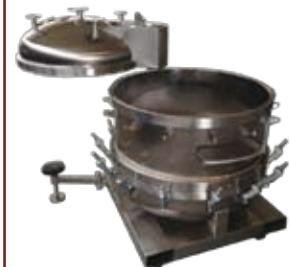
Промышленные друк-фильтры оснащаются поворотным механизмом или лифтом для разбора конструкции.
