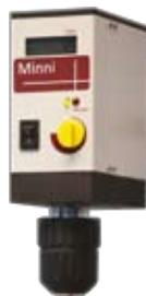
Компактный привод мешалки со шкалой может быть заменён на привод с дисплеем (иные варианты – по запросу)
