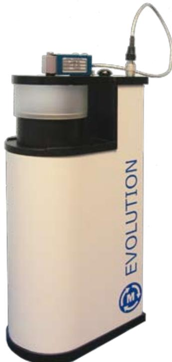
Реометр порошков Revolution оценивает склонность порошков к течению, консолидации, грануляции, трамбованию и упаковке. Анализатор имеет барабан, в который загружается образец. Видеокамера записывает поведение порошка во время вращения барабана. На базе собранных изображений фиксируется несколько аспектов, включая потенциальную энергию, угол, поверхностные фракталы и объём.
