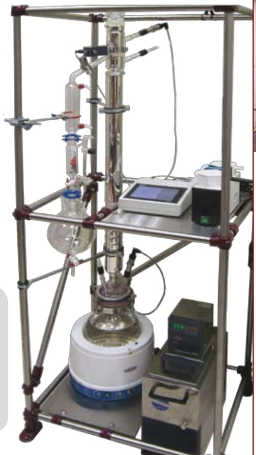
Обычно колонны имеют насыпную насадку: призматическую насадку из нержавеющей стали или стеклянные кольца Рашига, если необходимо исключить контакт с металлом. Как правило, колонна имеет вакуумную рубашку с зеркальным покрытием, что обеспечивает эффективную теплоизоляцию.
