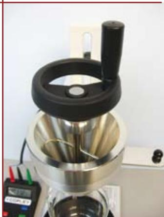
Тестер с воронкой может быть оснащён ручной мешалкой.
