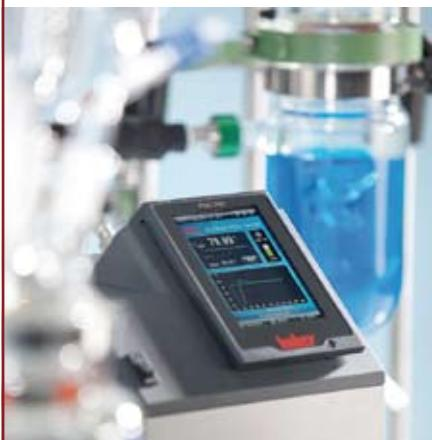
Терmostаты Ministat имеют встроенный компрессор, который охлаждается проточной водой (модель с символом W) или встроенным вентилятором (без символа).
