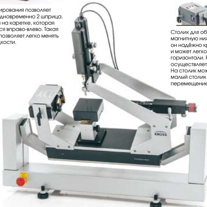
Прибор DSA25 можно разместить на наклонное основание, чтобы изучать краевые углы под углом, в том числе, угол скатывания.
