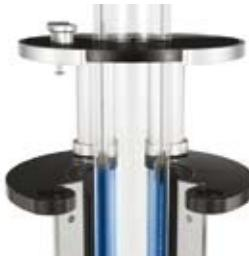
Специальное крепление позволяет легко фиксировать длинную стеклянную колонку в приборе.
