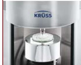
Терморубашка позволяет держать определенную температуру образца по время измерения
