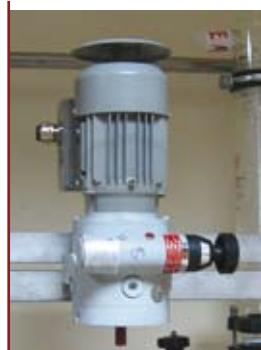
Реакторы Soffi оснащаются мощными промышленными двигателями в обычном или взрывобезопасном исполнении.
