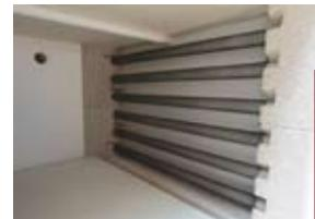
Открытые нагревательные элементы покрыты слоем изоляции. Отличительная особенность: простота и высокая скорость нагрева.
