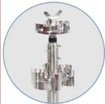
Двухступенчатая установка DBI позволяет смешивать, гомогенизировать и прокачивать вязкие продукты без дополнительных насосов. Монтируется в днище ёмкости, из которой продукт попадает на лопасти центробежного насоса (1-я стадия).
