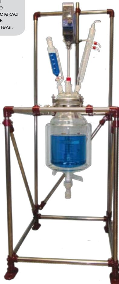
Стеклянные реакторы Steddy собираются на напольном стенде. Несколько реакторов могут быть объединены в единую систему.
