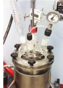
Стальные реакторы Romm могут быть оснащены стеклянной крышкой. Это позволит наблюдать за продуктом во время синтеза. При этом реакторы не будут работать под давлением.
