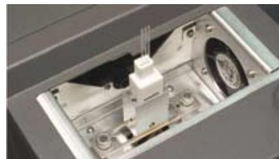
Компактный алюминиевый нагревающий блок находится под постоянным микропроцессорным контролем, что обеспечивает линейное возрастание температуры.
