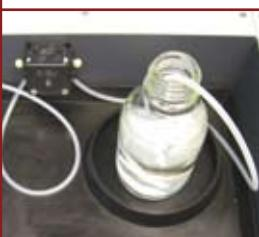
Сушка имеет фильтр для воздуха на входе и на выходе.
