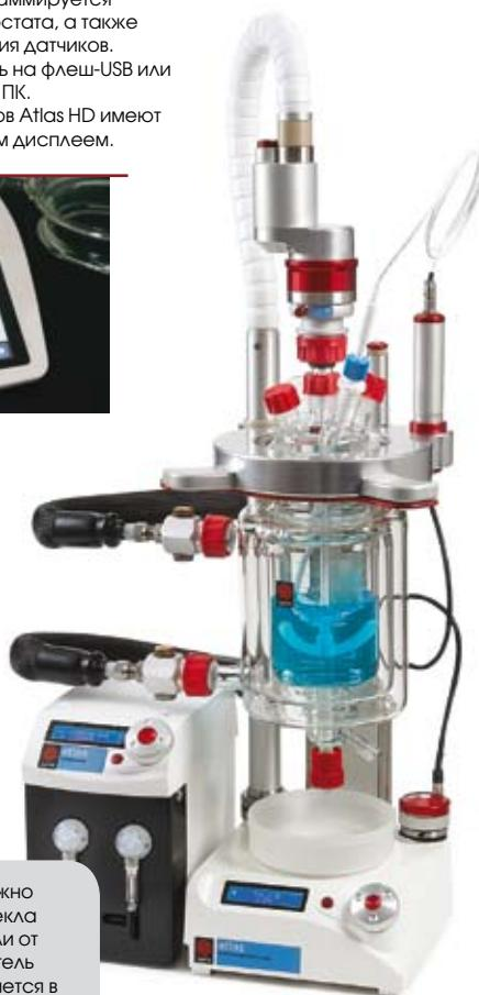
На одном реакторе можно вывесить ёмкости из стекла или нержавеющей стали от 50 мл до 5 л. Теплоноситель из рубашки легко сливается в термостат нажатием одной кнопки.
