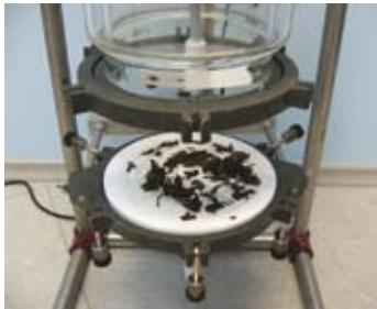
Фильтры LETI имеют разборную конструкцию. Прижимное кольцо позволяет использовать тканевую, бумажную или иную фильтровальную основу.
