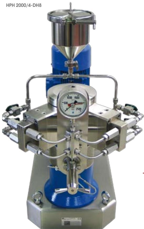
Получение эмульсий и суспензий нанодиапазона посредством спонтанной декомпрессии жидкости с давления 2000 бар до давления окружающей среды.
