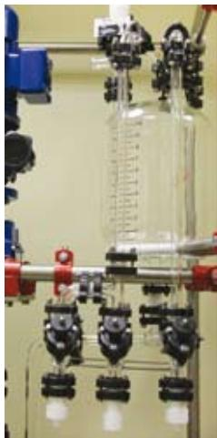
Загрузка реагентов в реактор осуществляется вручную (через люк), через мерную ёмкость или насосом.
