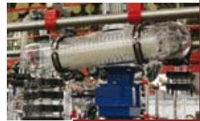
Сpirальный конденсатор имеет вертикальное или диагональное размещение. С помощью флемоделителя конденсат можно собрать в отдельную приёмную ёмкость.
