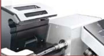
Тензиометр SDT работает со сменными капиллярами. Оператор заполняет капилляр тяжелой фазой, дозирует каплю лёгкой фазы и помещает в прибор. Пока идёт измерение, можно подготовить следующий капилляр с образцом.
