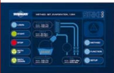
Роторные испарители Strike оснащены цветным дисплеем для управления процессом. Любые ошибки приведут к блокировке питания испарителя.
