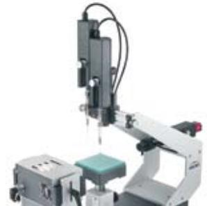
Столик для образца имеет магнитную нижнюю часть, поэтому он надёжно крепится на приборе и может легко перемещаться по горизонтали. Регулировка высоты осуществляется колесиком. На столик можно установить малый столик с микрометрическим перемещением.
