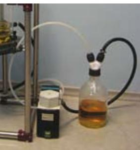
В качестве приёмника фильтрата предлагается стеклянная бутыль, которую легко переносить или менять. Её также можно использовать для хранения фильтрата.
