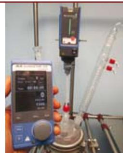
Модели EUROSTAR CONTROL оснащены съёмным беспроводным дисплеем, на котором отображается заданная и текущая скорость вращения, крутящий момент, температура и время. По изменению крутящего момента (нагрузки на вал) можно судить об изменении вязкости продукта.
