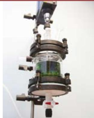
В нутч-фильтре с рубашкой можно проводить синтезы, в ходе которых выпадает осадок. После стадии реакции осадок легко отделить от жидкости (отфильтровать) и снять с фильтра.
