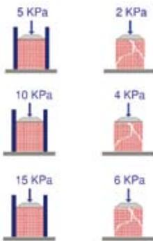
Реометр порошков Evolution позволяет определить неограниченную силу сдвига (критическую точку течения) порошков и гранул, т.е. силу, необходимую для разрушения / деформации свободно лежащего материала. Эта сила может измеряться как при одном давлении, так и при нескольких, что позволяет построить функцию течения.
