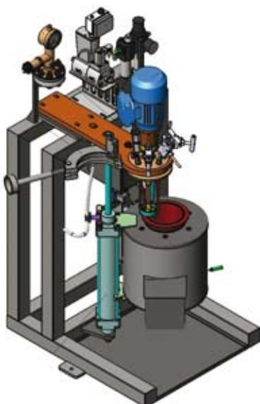
Крышка крепится к сосуду с помощью кулачкового зажима (на небольшие давления) или с помощью шпилек и гаек. Уплотнения метал к металлу и кольцевого типа обеспечивают безопасную работу.
