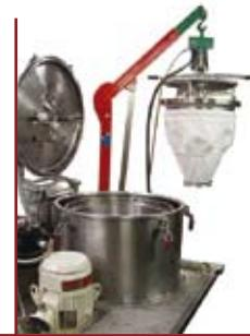
Фильтрующие центрифуги работают непрерывно, пока не заполнится мешок. Выгрузка мешка производится вручную или с помощью крана (на больших моделях).
