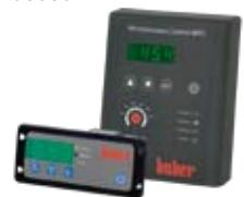
Контроллер CC-ONE с графическим дисплеем позволяет контролировать температуру по внешнему датчику температуры
