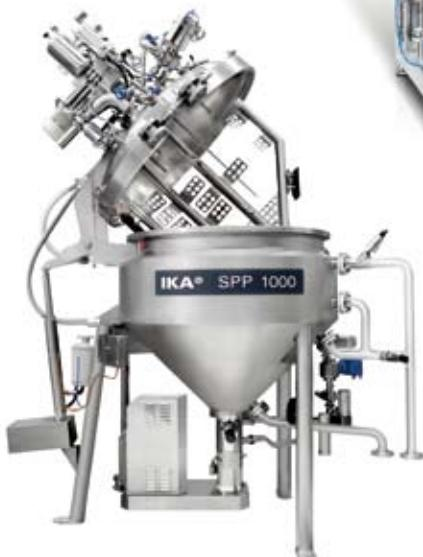
В основе установок MP и SPP лежит машина DBI, которая позволяет подавать сухие и жидкие компоненты сразу в рабочую камеру.
