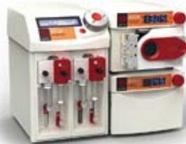
Для проведения реакции в потоке базовый комплект реактора включает шприцевой двухканальный насос, реактор и модуль контроля давления. Влияние температуры на ход реакции можно оценить с помощью специального модуля.
