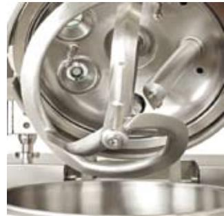
Сpirальная мешалка интенсивно перемешивает в радиальном и тангенциальном направлениях. Мешалка имеет полуую конструкцию и может обогреваться, что ускоряет процесс сушки.
