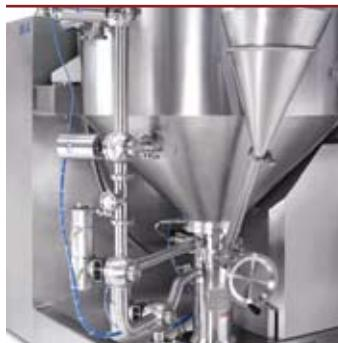
Машина DBI лежит в основе конических реакторов MP и SPP, на которых получают вязкие многокомпонентные продукты.
