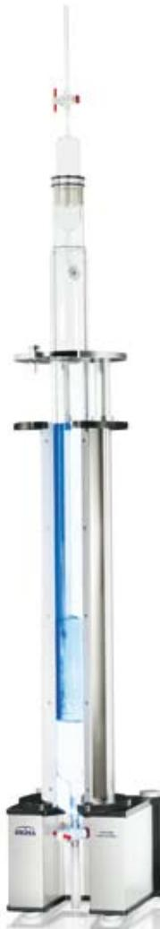
В анализаторе пены по Россу-Майлсу используются стандартные колонки длиной 1 м. Но высота пены фиксируется фотоэлементами, расположенными вдоль колонки. Данные передаются в программу.
