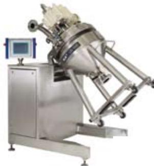
Наклонное положение ёмкости (опция) способствует перемешиванию и ускоряет сушку продукта.
