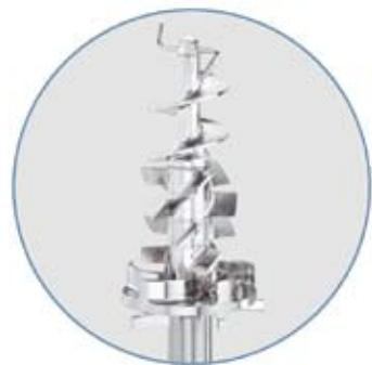
Модуль MHD позволяет насыщать жидкость сухим веществом (до 80%) в потоке. Жидкость входит в рабочую камеру сбоку, а порошок подаётся сверху по шnekу. В камере на элементах ротор-статор порошок равномерно распределяется в жидкости.
