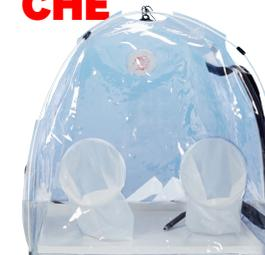
CHE (среда с контролируемой влажностью) позволяет изготавливать и тестировать таблетки при заданной влажности. Как влажность влияет на уплотнение основных фармацевтических материалов, понимание и контроль воздействия влажности часто имеют важное значение для успешной рецептуры..
