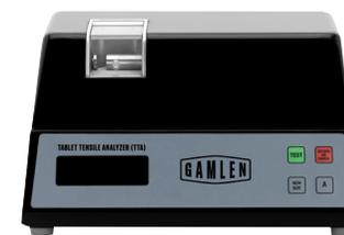
Gamlen TTA (анализатор прочности таблеток) измеряет диаметр таблетки и разбивает таблетки для измерения напряжения разрушения таблетки при растяжении. Значения автоматически фиксируются программным обеспечением Gamlen Dashboard. При всех расчетах учитываются размер и форма таблетки, поэтому данные можно сравнивать с полученными результатами на других приборах.
