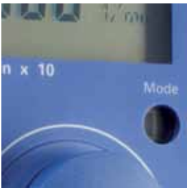
Встроенный дисплей для индикации вращающего момента с целью контроля вязкости.
