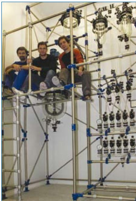
Перед отправкой пользователю реакторная система собирается в сервисном центре ТИРИТ. Если в ходе сборки выясняется, что что-то не учтено при расчётах, то при предварительной сборке это корректируется, чтобы заказчик получил работоспособную установку. По желанию заказчик может присутствовать на стадии предварительной сборки.
