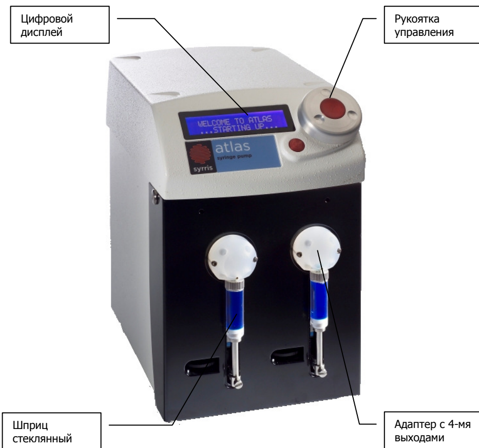
Одним насосом можно одновременно подать один реагент в 10 реакторов или 2 реагента в 5 реакторов
