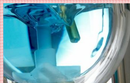
Оптоволоконный ART-датчик для работы в среднем ИК-спектре
