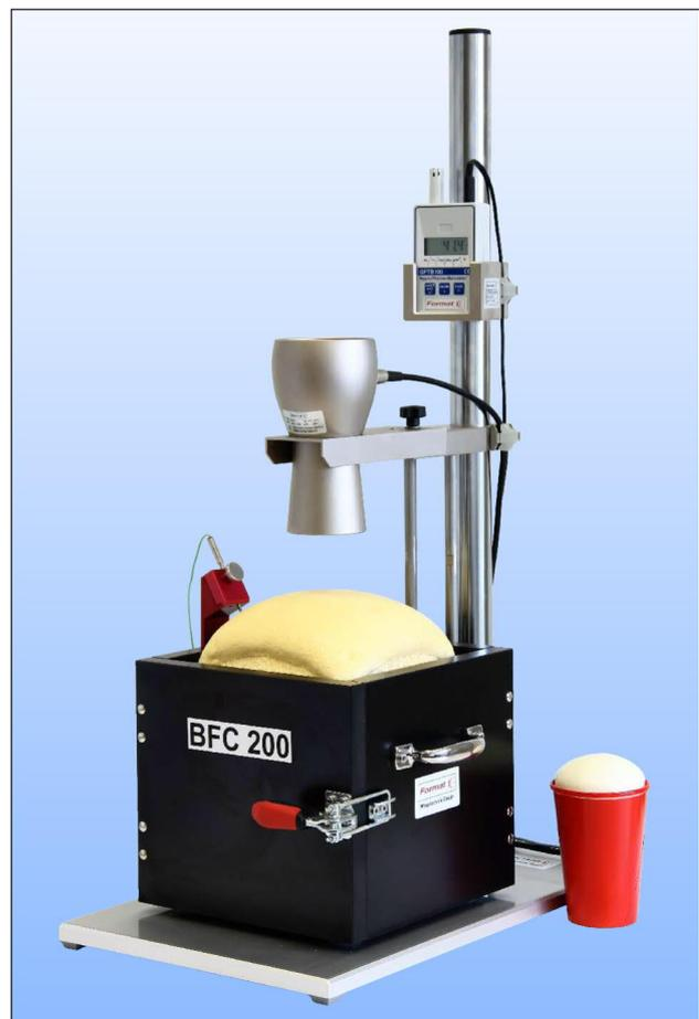
**Рис. 7:** Контейнер-короб **BFC 200** (Box Foam Container) помещается на основании стенда. Термопара вставляется в пену с помощью специального держателя для размещения. данные об окр.среде измеряются метеостанцией **GFTB**.
