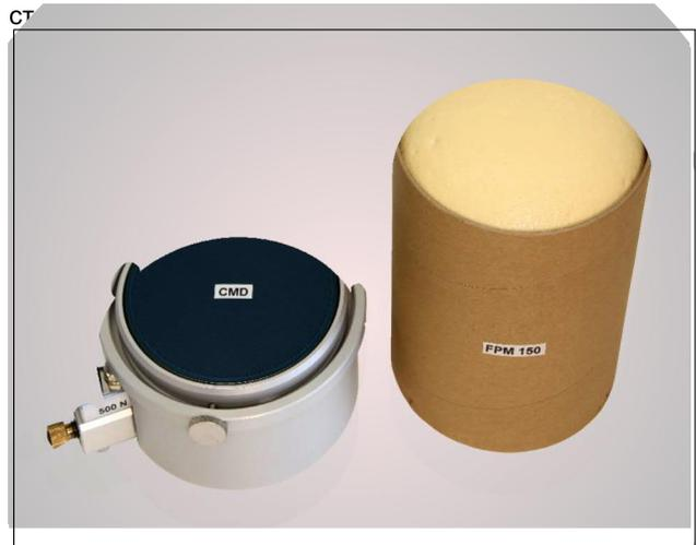
**Рис.3:** Картонный цилиндр (справа) с отвержденным образцом пены можно извлечь из FPM 150. Датчик CMD (Curing Monitor Device) устанавливается поверх прижимной плиты FPM 150 (слева). Это позволяет одновременно измерять диэлектрическую поляризацию и повышение давления.
