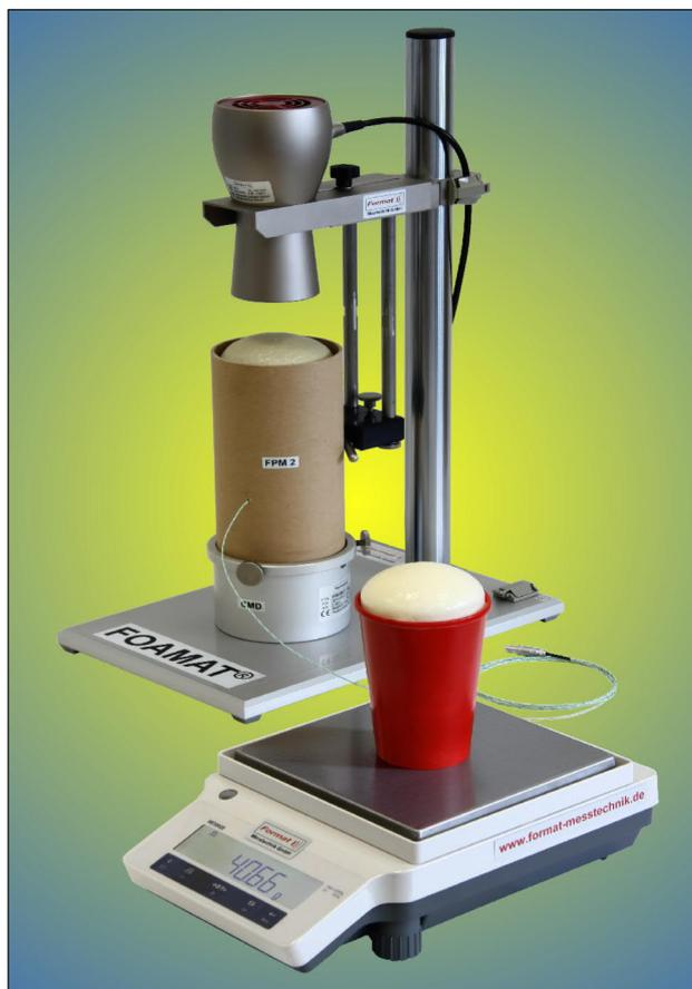
**Рис. 5:** Потеря веса измеряется лабораторными весами, встроенными в систему FOAMAT. Для этой цели используется остаток пены, оставленный в чаше для смешивания.
