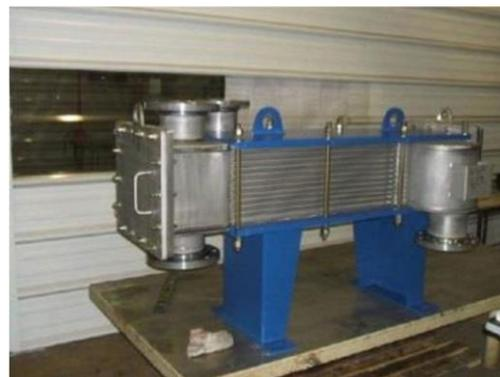
Теплообменники Platular® имеют 3 исполнения исходя из доступа к внутренней поверхности и очистки.
