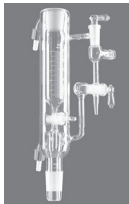
Приёмник дистиллята градуированный с прямым адаптером и термостатируемой рубашкой Подключение вакуума: GL
