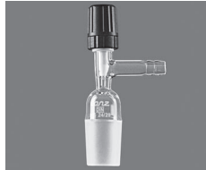
Игольчатый клапан для эксикатора (турбулентия сбоку)
