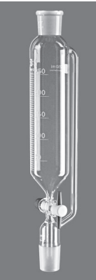
Капельная воронка цилиндрической формы, с градуировкой, имеет отвод для выравнивания давления. Удобна для работы под вакуумом. Может иметь стеклянную или тефлоновую втулку.
