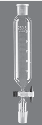
Классическая капельная воронка цилиндрической формы, с градуировкой. Может иметь стеклянную или тефлоновую втулку.
