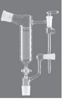
Приёмник дистиллята градуированный с изогнутым адаптером. Подключение вакуума: GL18
