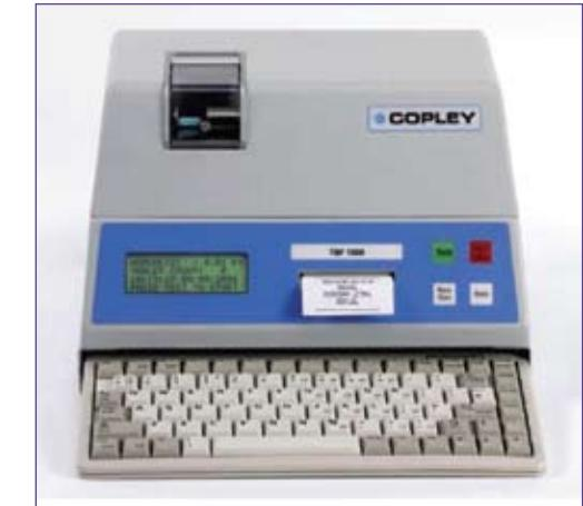
Компактный тестер прочности таблеток TFB 1000 прост в использовании: вся работа управляется с помощью трёх кнопок на передней панели, позволяющих задать параметры, провести эксперимент и вывести данные на печать. С помощью клавиатуры (опция) можно проводить более сложные операции и подсчёты. Специальные настройки позволяют изменить процедуру подсчёта таблеток в партии, начало эксперимента или процент разломов, что особенно важно при проверке мягких рассыпчатых или твёрдых таблеток.
