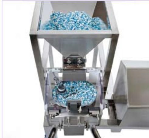
Компактные приборы для сортировки таблеток и капсул различной формы и размера позволяют взвесить каждую единицу продукта и отсортировать брак. Оператор просто загружает образцы в сортировщик, а на выходе получает данные о весе отдельного образца, среднем весе партии и заключение о партии в целом. Результаты можно распечатать в виде отчёта. Прибор соответствует требованиям GMP.
