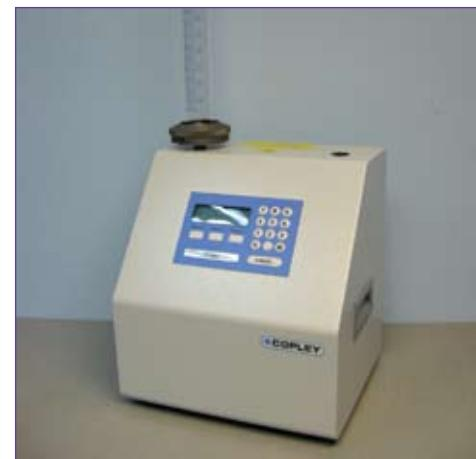
Прибор определения плотности после утряски серии JV был разработан для порошков, гранул и аналогичных продуктов в соответствии с Европейской и Американской Фармакопеей. Этот метод позволяет оценить текучесть порошков и количество оседающих частиц при транспортировке. Его можно также использовать для оптимизации упаковки, например, при производстве стиральных порошков.
