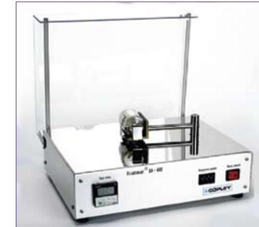
Прибор Friabimat SA-400 разработан для определения истираемости твёрдых пилюль и гранул перед дальнейшей обработкой. Может применяться как для таблеток с покрытием, так и без него, а также для лекарственных форм, для которых метод истирания в барабане не подходит. Позволяет определить разницу механических свойств между партиями.
