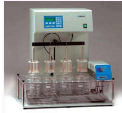
Приборы серии DTG для проведения испытаний на распадаемость таблеток соответствуют последним требованиям Европейской и Американской фармакопеи. Тестеры разработаны для контроля качества классических таблеток, таблеток с простым или долго растворяющимся покрытием, а также желатиновых капсул. Перед тем как таблетка или капсула растворится в организме, она должна быть разрушена на более мелкие части. Данный прибор позволяет разрушать таблетки и капсулы с воспроизведимым результатом.
