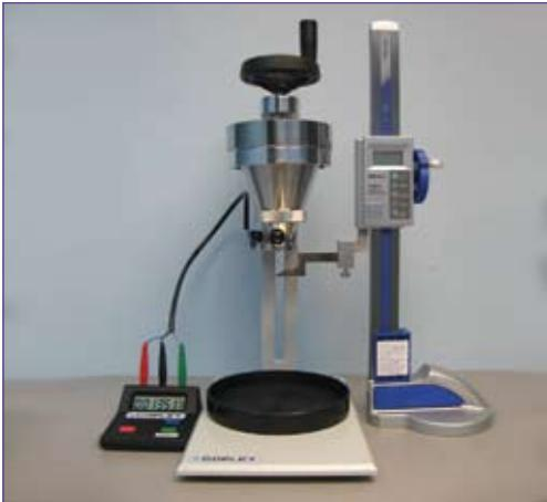
Прибор ВЕР2 изначально разработан для измерения текучести порошков и гранул через отверстие определённого размера (имеется два варианта теста: метод цилиндра и метод воронки). Далее анализатор был адаптирован для определения предельного сдвига. Метод сдвига используется для прогнозирования поведения мелкодисперсных порошков и сыпучих материалов в бункерах, питателях и другом подъёмно-транспортном оборудовании. Кроме того прибор позволяет определить угол покоя и предел сдвига в ячейке.
